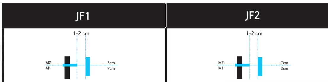
Длина магнита 3 см в направлении вверх и вниз между магнитом и магнитным выключателем кабины на медленной скорости пропорционален расстоянию, которое он проводит. В каждом лифте разные. Два магнита на уровне пола двух выключателей, которые нам нужны то, что он остается между ними декольте.
